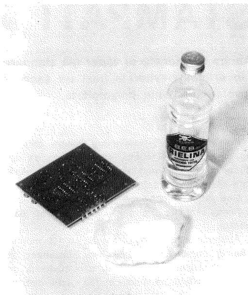
Fig. 2 Se lo stagno utilizzato contiene un disossidante di pessima qualità, prima di allimentare il circuito, pulite tutta la superficie passandovi sopra con un batuffolo di cotone imbevuto di trielina. Qualsiasi altro solvente, alcool, benzina ecc. servirà solo ad imbrattare maggiormente il circuito.
