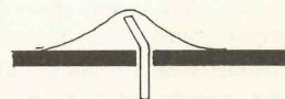
Fig. 21 Appoggiando il saldatore vicino al punto da stagnare e facendo fondere vicino a questo lo stagno, il disossidante brucerà eliminando tutti gli ossidi presenti e la stagnatura risulterà perfetta.
